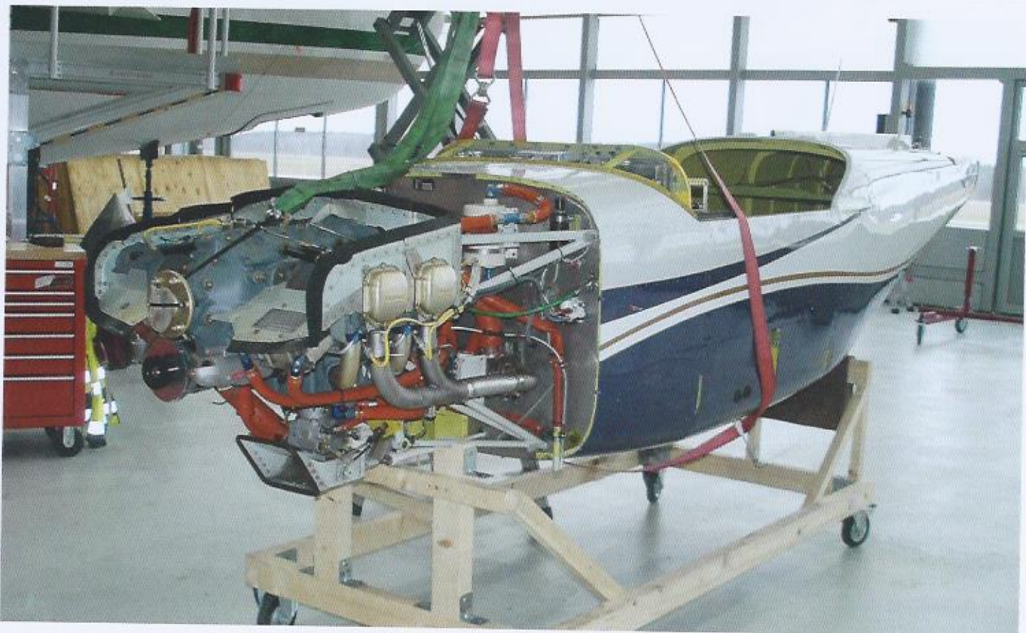
Oben: Optisch markant ist der neue Dreiblattprop mit sichelförmigen Blättern. Unten: Der zweite Prototyp in Arbeit. Der AE10-360 ist voll kunstflugtauglich und verträgt künftig auch bleifreies Mogas.
