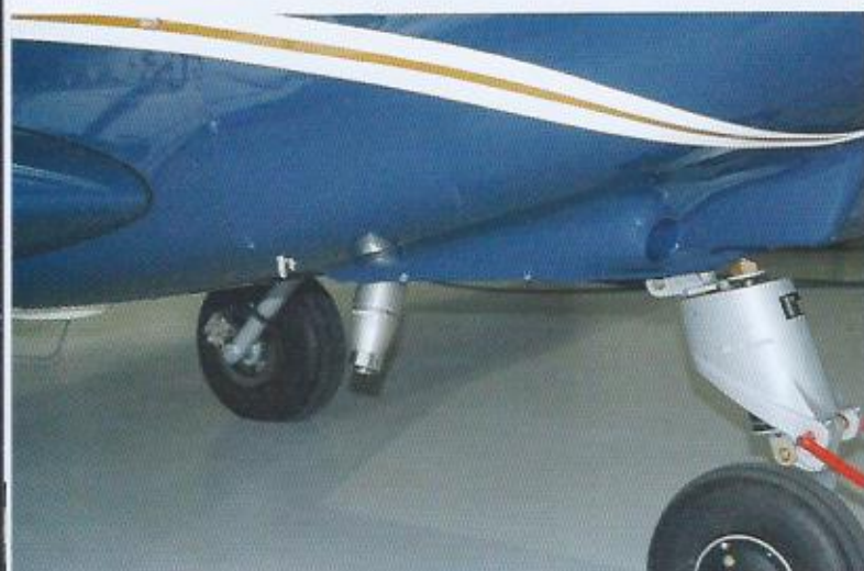
Unter der Cowling versteckt sich der nun innenliegende Gomolzig-Nachschalldämpfer.
