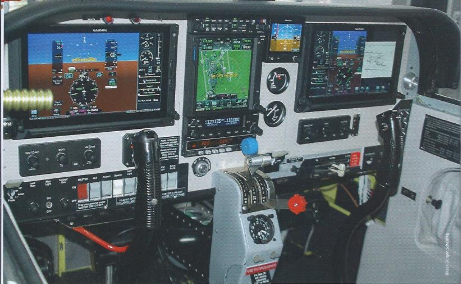
Voll IFR-tauglich ist das Glascockpit mit zwei G500TXi-Displays. Sogar ein TCAS ist in dieser Variante enthalten.
